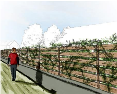
Mur surmonté d'un dispositif à claire voie doublé d'une haie
