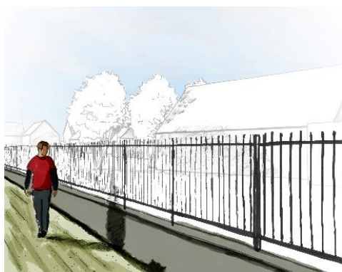
Mur bahut surmonté d'une ferronnerie
