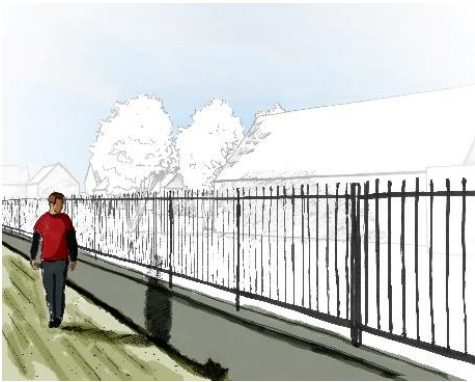
Mur bahut surmonté d'une ferronnerie
